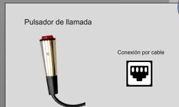
El monitor P163 recibe la señal del pulsador de llamada y es el encargado de enviar la señal de forma inalambrica al receptor
